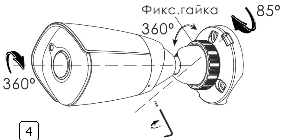
2. Настройте положение камеры, затяните фиксирующую гайку. Камера установлена.
